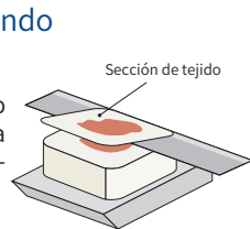
Se realiza una sección de tejido del grosor especificado utilizando una cuchilla. Al mismo tiempo, la sección de tejido se fija sobre la marcha a la cinta transportadora.
