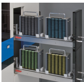
Unidad de cámara de secado de 400 portaobjetos
