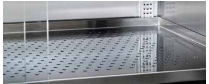
Estantes ligeramente inclinados hacia el centro para evacuación de posibles derrames hacia la cubeta de retención de líquidos (sistema opcional).
